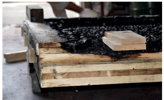
Beflammung mit 1.000 °C: nur wenige Zentimeter Abbrand.
