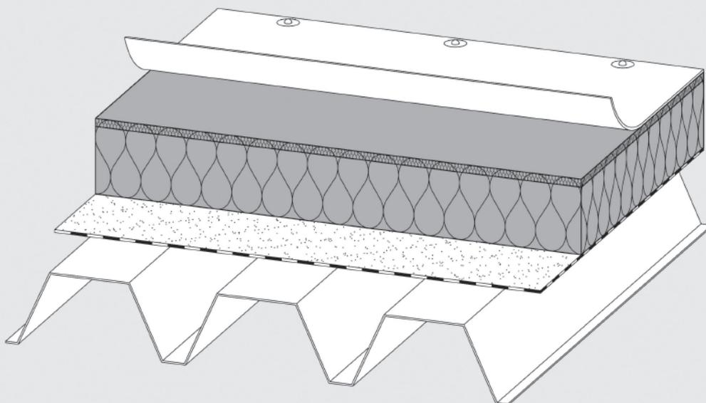
Steinwolle-Dachdämmplatte mit erhöhter Punktbelastbarkeit durch integrierte Zweischichtcharakteristik. Aufgrund ihrer hoch verdichteten, lastverteilenden Oberlagen bietet sie eine verbesserte Widerstandsfähigkeit gegen mechanische Beanspruchungen.
