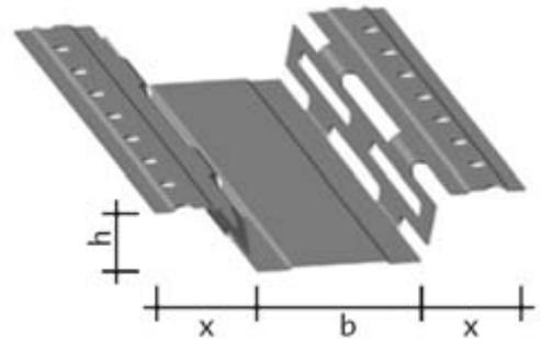
Rigips Hut-Federschienen sind korrosionsschutzte Metallprofile, die zur direkten Befestigung von Bekleidungen in Gipsplattensystemen dienen. Rigips Hutfederschienen sind vielseitig einsetzbar und weisen eine kontinuierliche Lochung zur Befestigung am Untergrund auf. Rigips Hutfederschienen werden aus Stahlblech nach DIN EN 10327 gefertigt.
